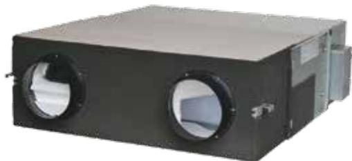
Durante il funzionamento invernale recuperano parte dell'energia, contenuta nell'aria di rinnovo espulsa dagli ambienti, che diversamente andrebbe dispersa nell'atmosfera, utilizzandola per pre-riscaldare l'aria in entrata dall'esterno.
