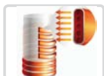
Scambiatore piatto a microcanali in alluminio (maggiore superficie di contatto col serbatoio e migliore scambio termico)
