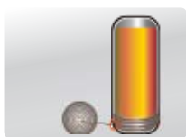
Uteriore avvolgimento tubiero sul fondo del serbatoio "effetto nido" (maggiore volume utile ACS)
