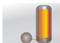
Uteriore avvolgimento tubiero sul fondo del serbatoio "effetto nido" (maggiore volume utile ACS)
