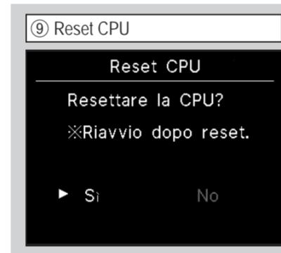
Si resettano i microcomputer delle unità interne ed esterne collegate. (Condizione di ripristino dopo un'interruzione di corrente)
