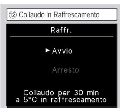
Questo può essere azionato mentre il raffrescamento è arrestato. Se la temperatura ambiente è troppo bassa per avviare la prova di raffrescamento, l'unità opererà per 30 minuti con impostazione di temperatura ridotta 5°C.
